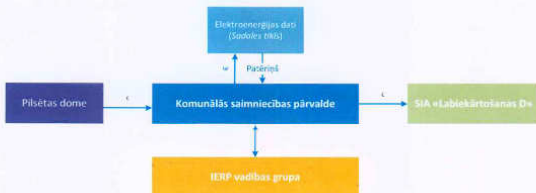
5.2.attēls. Monitoringa sistēma ielu apgaismojumam
