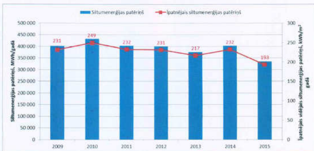
2.12.attēls: Kopējais siltumenerģijas patēriņš ēkās Daugavpilī un īpatnējais vidējais patēriņš gadā (avots: PAS „Daugavpils siltumtīkli”)
